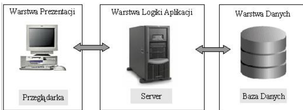
Rys. 1: Struktura architektury trójwarstwowej
